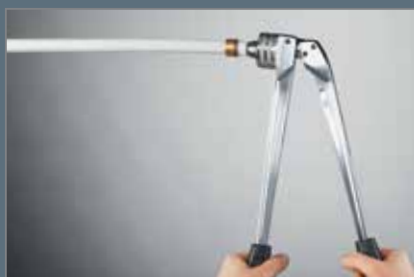
Нанизывание пресс-втулки на трубу и расширение трубы
